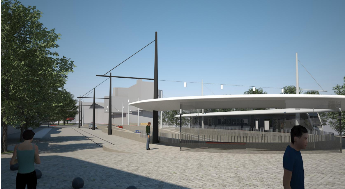
Tramhalte Maasboulevard/Mosae Forum vanaf van Hasseltkade. De spoorzijde aan van Hasseltkade is in de 1e fase een calamiteitenhalte en zal zeer incidenteel gebruikt worden. Een perronkap is hier in de 1e fase niet functioneel. De perronkap is zodanig ontworpen dat in de vervolgfase deze geschikt is voor uitbreiding tot een volwaardige halte op de van Hasseltkade. Het spoor aan de van Hasseltkadezijde dient in de 2e fase verlegd te worden.
