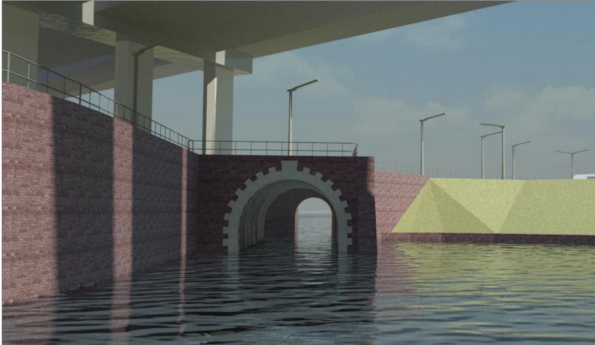
Perspectief Monumentale duiker (optie 2 'zoals het was'). De landschappelijke inrichting met taluds en beplantingen dient in samenhang met de plannen voor Noorderpark en Noorderbrug uitgewerkt te worden.
